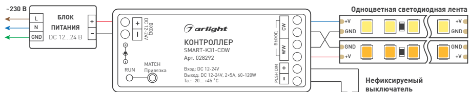
Рис. 2. Допустимая схема подключения контроллера (ток на ленту должен быть не выше 2.5 А).
