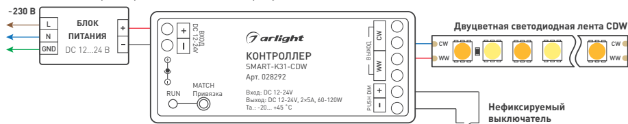
Рис. 1. Схема подключения контроллера с лентой CDW.
