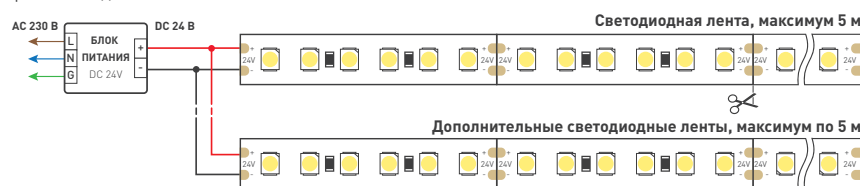
Схема 1. Подключение нескольких светодиодных лент с одной стороны
