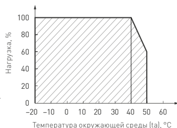
Рис. 4. Зависимость максимальной допустимой нагрузки, % от температуры корпуса
