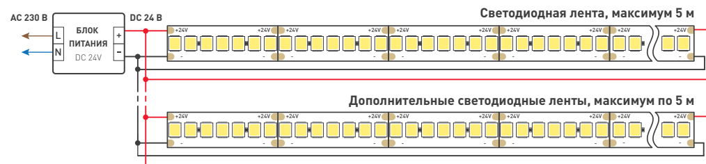
Схема 2. Подключение нескольких светодиодных лент с двух сторон
