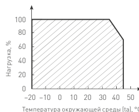
Рисунок 4. Максимальная допустимая нагрузка, % от мощности источника
