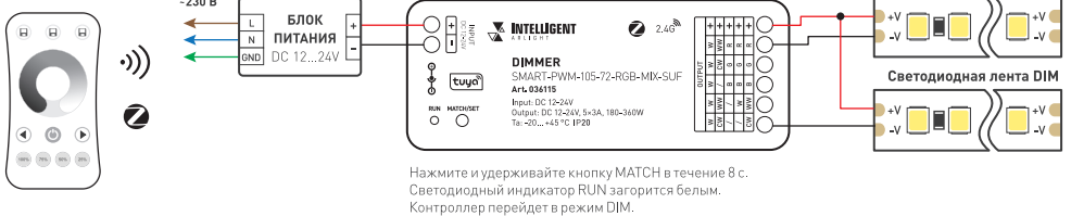
Рис. 1. Схемы подключения диммера SMART-PWM-105-72-RGB-MIX-SUF
