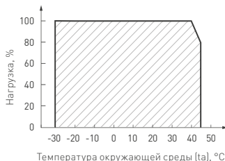
Рис. 2. Максимальная допустимая нагрузка, % от мощности источника
