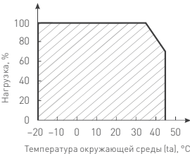
Рисунок 4. Максимальная допустимая нагрузка, % от мощности источника
