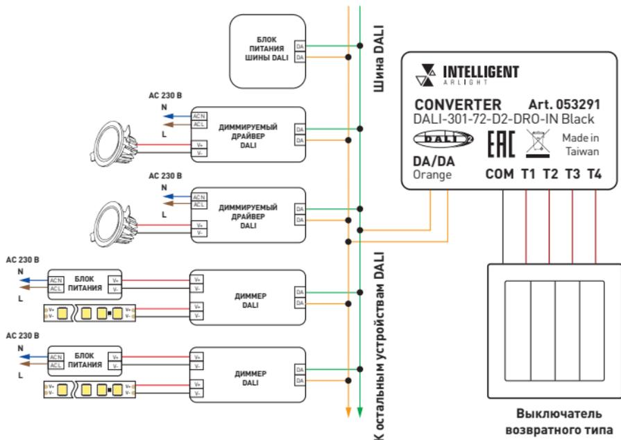
Рис. 1. Схема подключения конвертера
