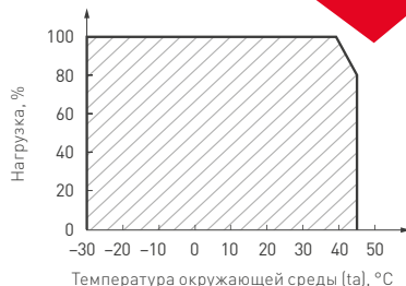
Рис. 2. Максимальная допустимая нагрузка, % от мощности источника
